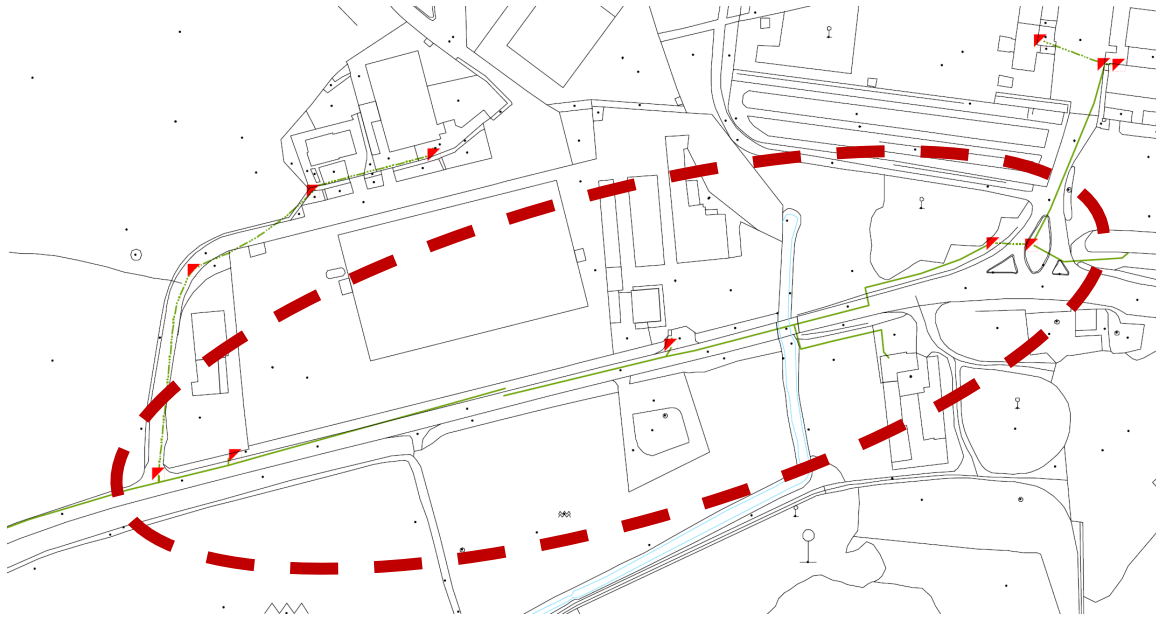
Estratto elaborato sottoservizi – Rete Telecomunicazioni
